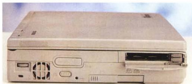
Vista frontale, laterale e posteriore del Tecra 500. Il grosso connettore in alto è utilizzato per il collegamento alla Card Station opzionale (vedi testo).
